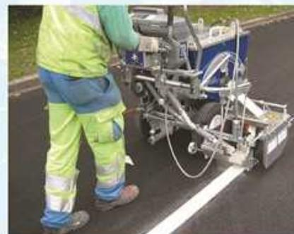
◆ Machine à marquage routier (Road Marking Machine)
