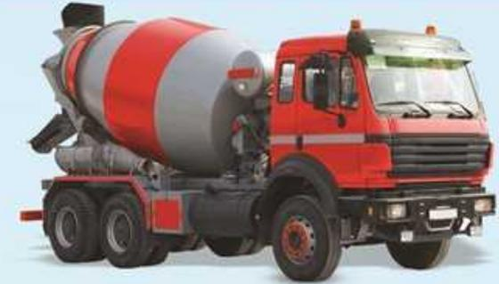
Malaxeur à béton (concrete mixer truck)
