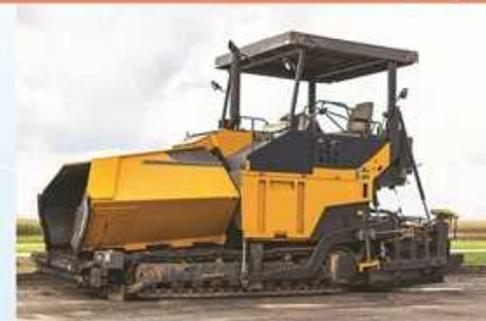
◆ Finisseur de bitume (Asphalt Paver)
